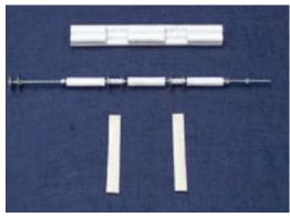
I. Aquí vemos el eje principal en el centro de la imagen, y las dos correas en primer plano. Al fondo vemos la vigueta que soportará el eje principal. La vigueta consta de 3 tubos de papel fuerte, enrollados alrededor de una varilla de madera, utilizando dos capas de papel en formato apaisado y dos tubos utilizando dos capas de papel en formato
