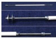
4. Como queremos que el rotor gire suavemente, el eje debe girar en un rodamiento. Utiliza 2 hojas de papel 4 (en formato apaisado) para enrollar un tubo rígido con la varilla de madera. Pon el eje a través del tubo (imagen superior). En el extremo de la izquierda puedes montar el rotor de velas (centro), y en el de la derecha puedes colocar un cordel entre las dos tuercas para levantar objetos con el rotor. Pon un corcho o botón en el extremo saliente del eje por seguridad.
