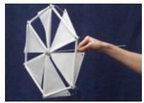
**3.** Pon la varilla roscada a través del agujero del centro del rotor, y fija el rotor utilizando una gran arandela y una tuerca a cada lado del mismo. Utiliza una llave para apretar los tornillos. Las velas se fijan a la estructura del rotor utilizando bridas (en el centro), tuercas y cordeles (en los extremos). Puedes simplemente pasar el cordel alrededor del tornillo más cercano y hacer un nudo.
