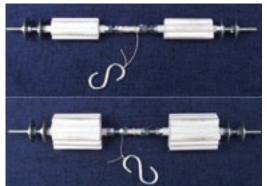
4. Este es el aspecto que deben presentar los 2 ejes lentos (utiliza las dos varillas roscadas pequeñas). Las dos arandelas grandes en ambos extremos del eje hacen que se mantenga en su sitio. Se fijan utilizando dos tuercas para cada una. Los engranajes también se fijan mediante tuercas. Se introduce uno de los extremos del cordel entre las dos tuercas, y
