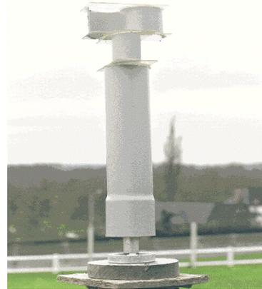
Fig IV.15.- Aerogenerador Savonius
