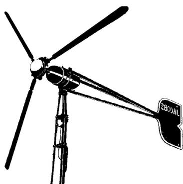
Fig V.1.- Aerogenerador Jacobs de 1 kW
